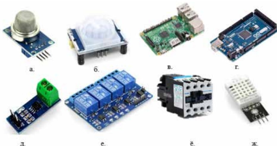
Зураг 2. а. угаарийн хий мэдрэгч б. хөдөлгөөн мэдрэгч в. Raspberry Pi г. Arduino Mega25 д. гүйдэл мэдрэгч е. релей ё. соронзон пускатель ж. температур, чийгшил мэдрэгч
