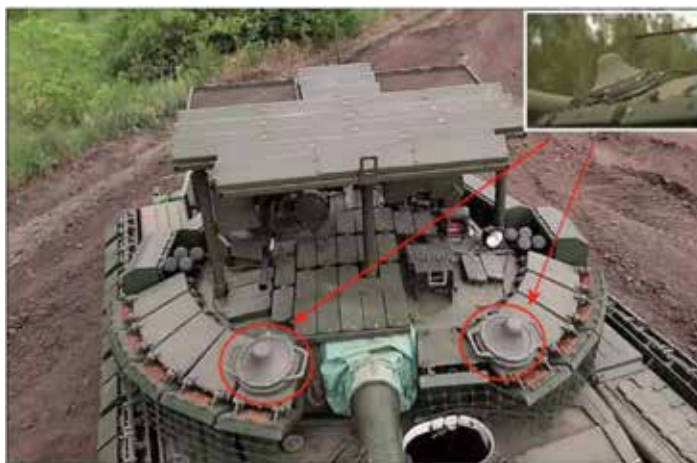
Зураг 4. Волнорез төхөөрөмжийг танкан дээр суурилуулсан байдал
